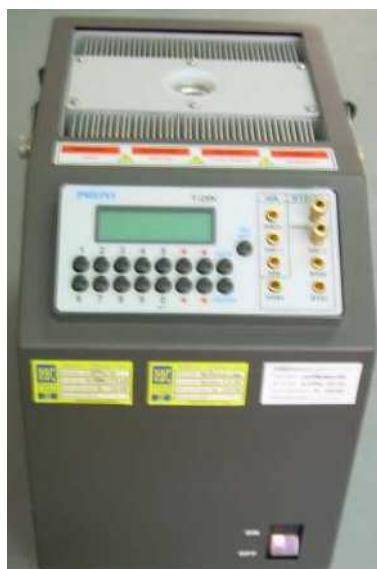
Figura 3.13 - Banho térmico utilizado para aferição dos sensores.
