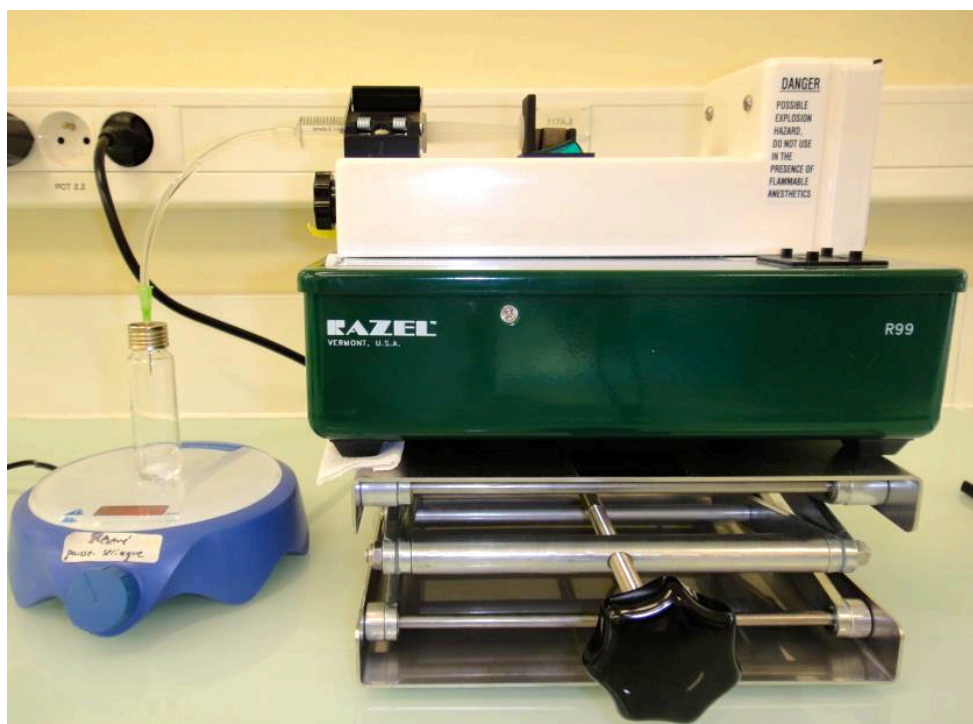
Figura 5.1. Imagem fotográfica do sistema utilizado na preparação das partículas automontadas.
