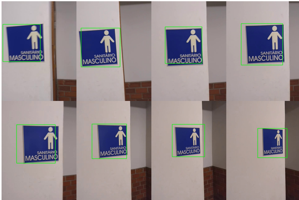
Figura 4.1: Exemplo de frames processados com demarcação da placa encontrada. Esse vídeo é o mesmo apresentado na Figura - 3.4
